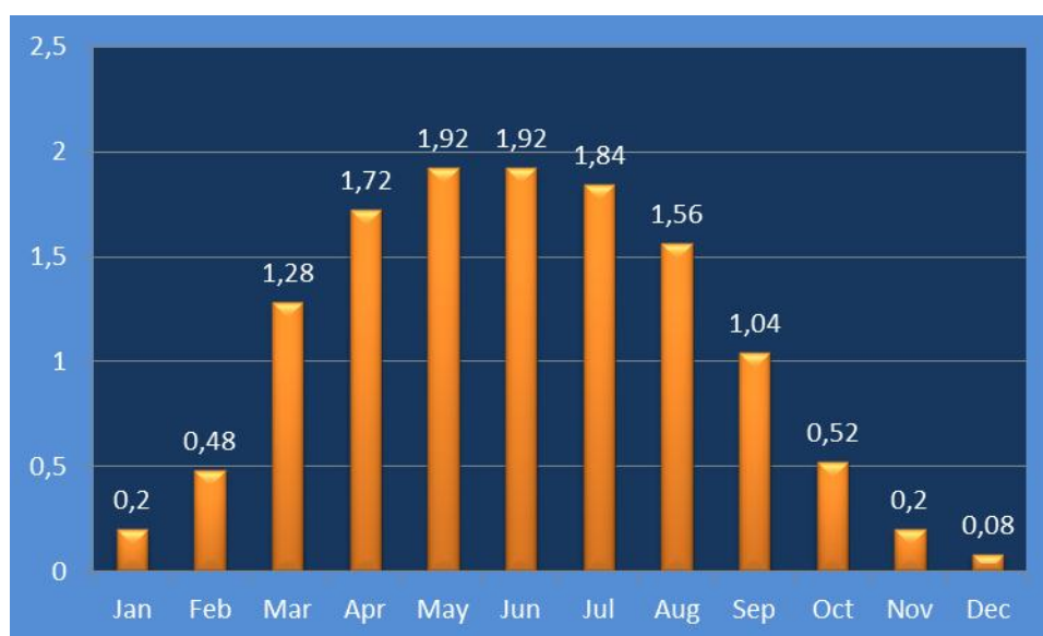
Рис.1 Средняя выработка энергии в течение суток для солнечной батареи 100Вт в кВт*ч.
